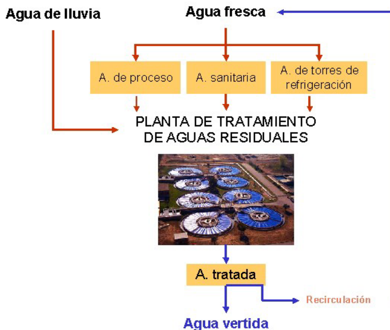
Figura xxxiii. Tratamiento de aguas residuales
